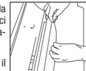
4) Rimontate la parabola appoggiando il lato lungo contro i supporti inferiori sul coperchio. Esercitare poi una lieve pressione sulla parabola in corrispondenza dei fermi superiori, in modo da realizzare automaticamente l'aggancio.
